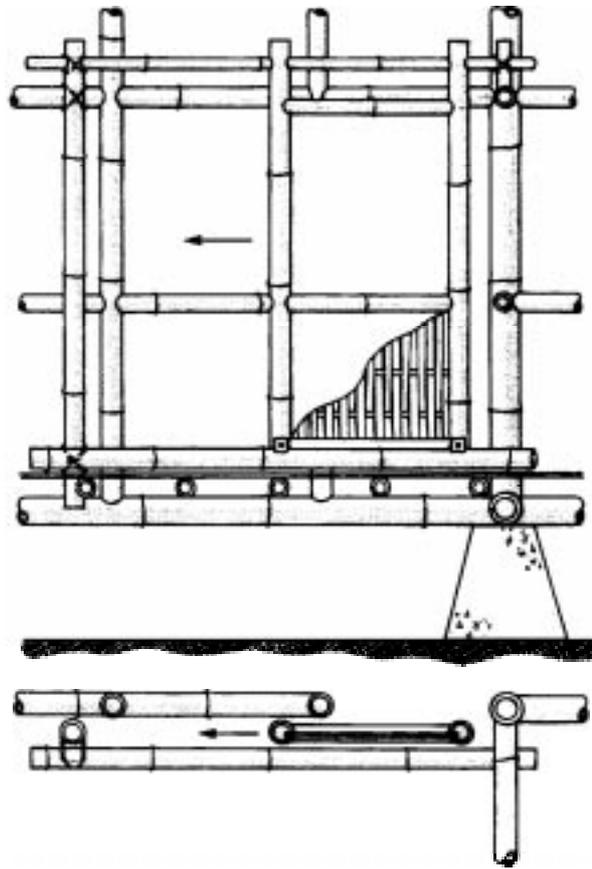
Figure 31: Arrangement of sliding door
